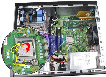
8. Soulevez le processeur pour le retirer du connecteur et placez-le dans un sac antistatique.
