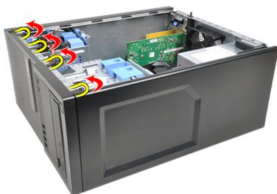
4. Tournez le cache pour l'écarter de l'ordinateur et libérer les crochets sur le bord opposé du cache sur le châssis .
