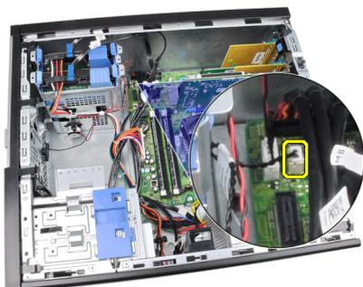
4. Retirez le câble du capteur thermique du clip du châssis.
