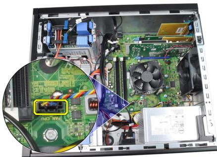
4. Desserrez les vis captives de fixation du dissipateur de chaleur à la carte système.
