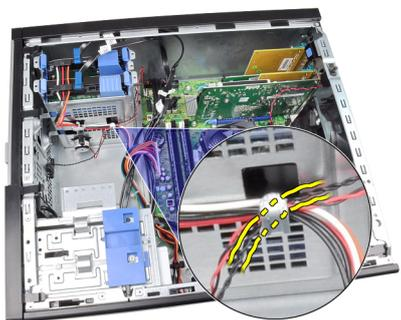
5. Ecartez le capteur thermique à l'avant du châssis et retirez-le.
