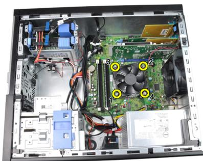
5. Soulevez le bloc dissipateur de chaleur et retirez-le de l'ordinateur. Posez le bloc en tournant le ventilateur vers le bas, la graisse thermique orientée vers le haut.
